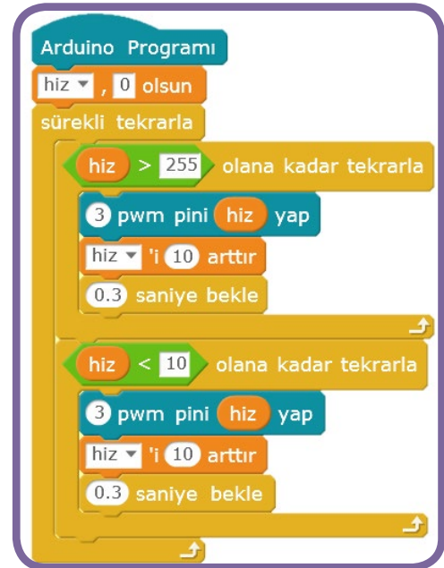
Şekil 148: Motor hız kontrol devresi kodları
