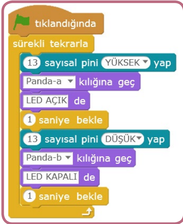
Şekil 137: İnteraktif mod led aç kapa uygulaması
